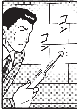
↑引張試験器(タイルを引っ張って強度を調べる) ↑打診棒(叩いた音で調べる)
